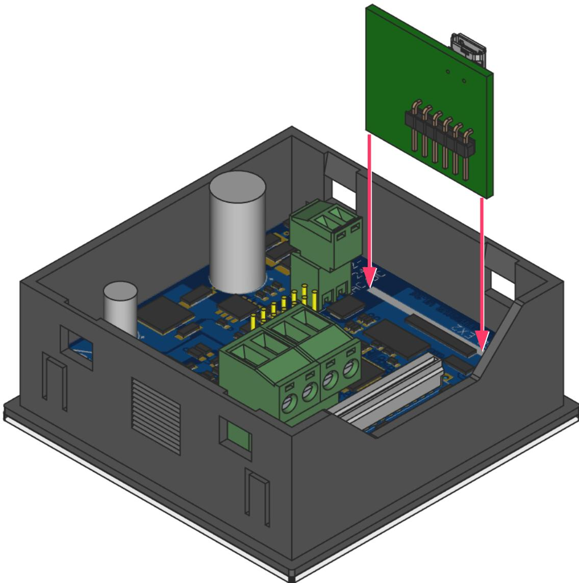
Die USB-Schnittstellenkarte an der mit „USB EX2“ gekennzeichneten Position auf die Platine des Digalox® DPM72-AV2 aufstecken. Darauf achten, dass alle Pins im Sockel stecken. Zur Verbindung mit dem PC wird ein USB-Kabel mit USB-Micro-B-Stecker benötigt.
